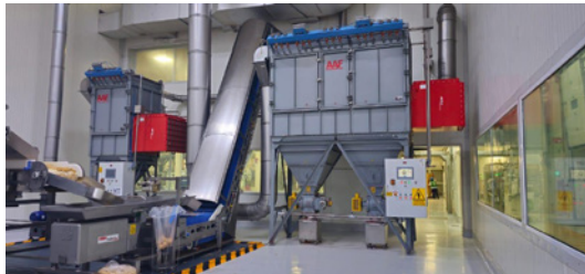
Meksika'daki bir gıda fabrikasına kurulan toz toplayıcı
