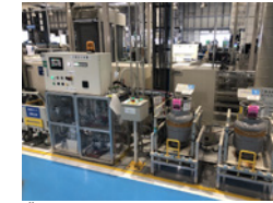
Üretim sürecinde soğutucu akışkanın geri kazanılması
