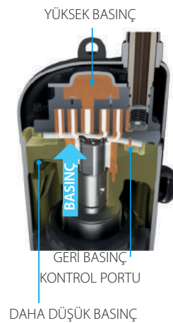
Çek valf içeren buhar enjeksiyonu yapısı
